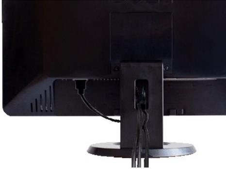
Depois de ligar todos os cabos necessários ao monitor e computador, (consulte [Conectando seu monitor](#) para obter informações sobre a ligação de cabos), utilize o suporte de cabos para organizar de forma eficiente todos os cabos tal como acima ilustrado.
